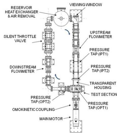
Figure 1. The CPRTF lay-out in SITAEL S.p.A.
