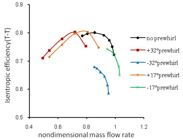
(d) Efficiency characteristic at 80,000rpm
